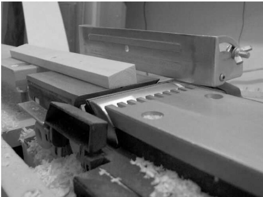
Non è un lavoro difficile ma ci vuole pazienza, e sono necessarie un po' di prove per riuscire a farlo della giusta misura. La piallatura viene fatta poco per volta confrontando il risultato con una dima dopo ogni passaggio.
