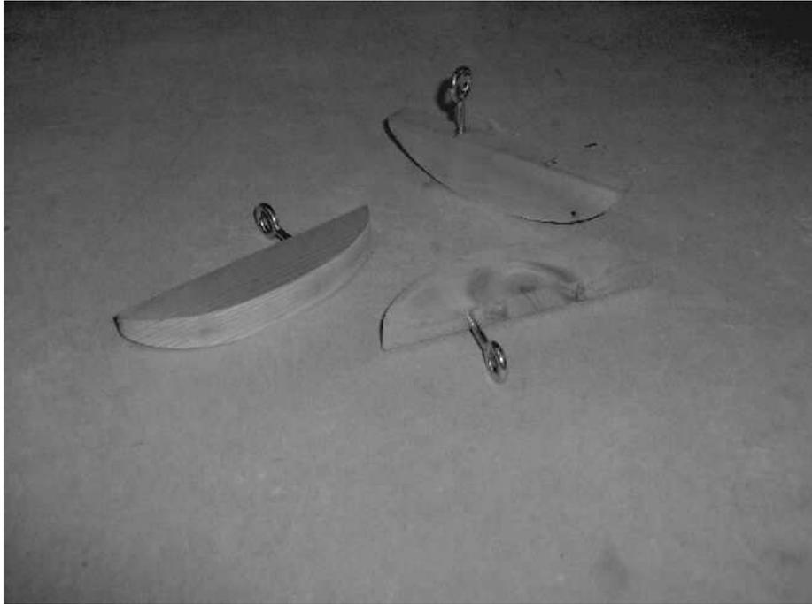
Per maneggiarle durante la verniciatura è utile avvitare in uno dei due fori di fissaggio una vite ad occhiello.
