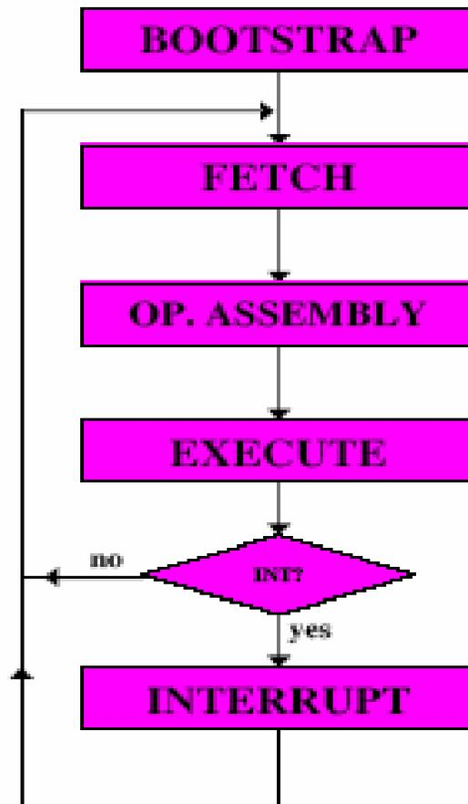
La soluzione comunemente adottata consiste nel permettere al “supervisore” di prendere il controllo del processore al termine di ciascun ciclo.
