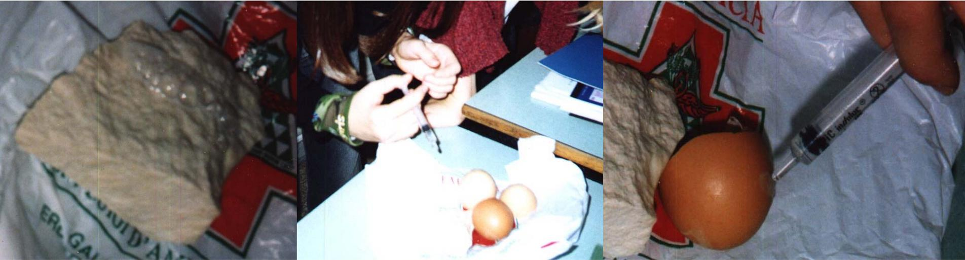
1) Abbiamo preso una roccia calcarea e con una siringa abbiamo fatto cadere delle gocce di acido muriatico. Abbiamo visto formarsi sulla superficie della roccia una effervescenza causata dalla reazione del carbonato di calcio con l'acido cloridrico, ottenendo così anidride carbonica.
