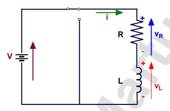
Il bipolo RL viene di conseguenza a trovarsi sottoposto bruscamente all'azione della f.e.m. costante (V) del generatore. La corrente però non può portarsi immediatamente al valore finale (V/R) ma ad esso si porta gradatamente impiegando un certo intervallo di tempo, secondo una legge esponenziale come riportato nella figura successiva, nella parte (a).
