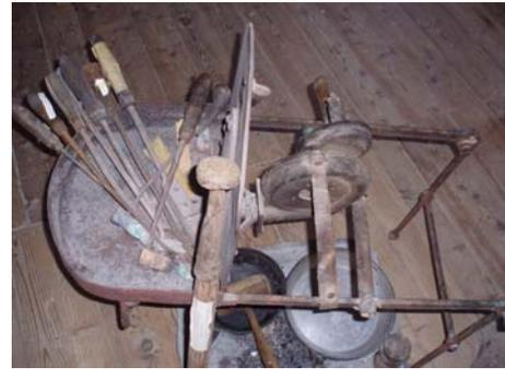
Idraulico: attrezzi che servivano per battere-sagomare i tubi di piombo per l'impianto di scarichi idraulici generali, specifico dei sifoni dei bagni e delle cucine.
