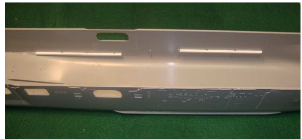
Foto degli appoggi per il ponte
