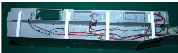
Sul lato destro della foto si vede lo spinotto di alimentazione di tutto il complesso elettrico.
