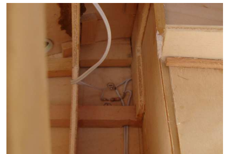
Questa è la foto dell'impianto di illuminazione delle cabine, realizzato con 4 mini-led ad alta luminosità che sono alimentati con una resistenza da 1000 ohm.
