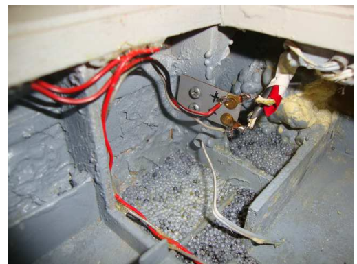
Tutti i fili di alimentazione sono stati portati all'interno dello scafo intubati in cannucce da bibita e fanno capo ad un connettore al quale si collegheranno tutti gli altri fili relativi all'illuminazione del modello.
