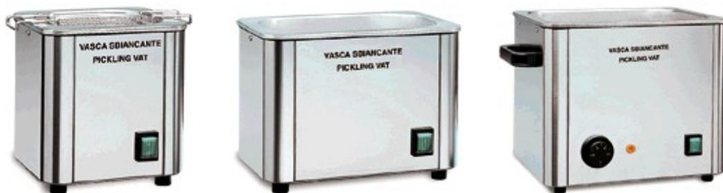
La tecnologia a bagno decappante è una operazione che normalmente avviene mediante immersione in una soluzione di acido e serve per rimuovere quella patina di ossidazione nera presente sulla superficie dei metalli dopo una fusione ad alta temperatura.
