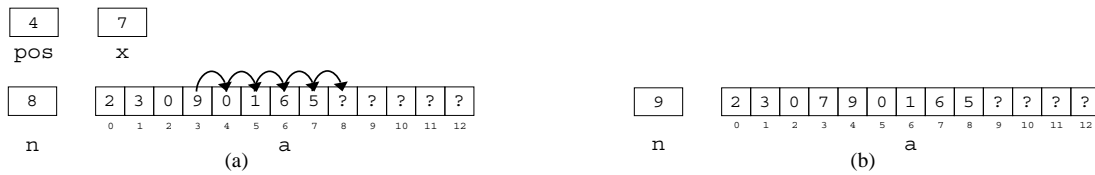
Figura 6.7: Scompattamento di liste rappresentate mediante array e riempimento: prima (a) e dopo (b) l'operazione.
