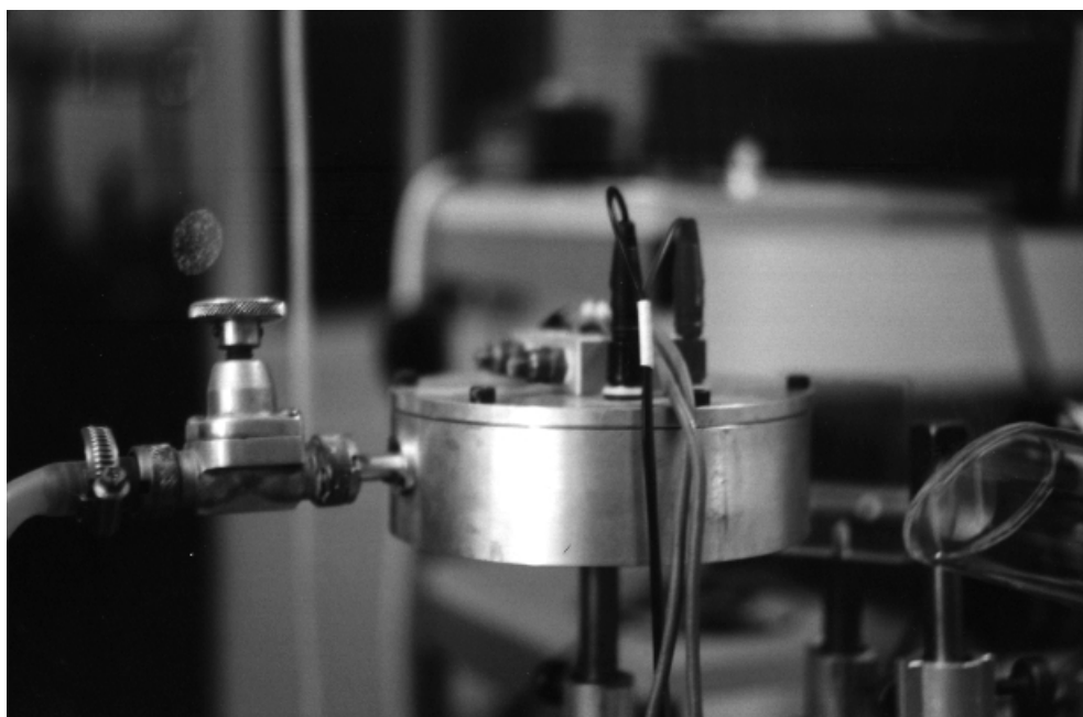
Fig. 2. Particolare dell'alloggiamento del diodo laser utilizzato nel sistema spettroscopico. Nel contenitore di alluminio che ospita il laser e lo scambiatore termico può essere fatto il vuoto (si noti il rubinetto sulla sinistra). Sulla destra si può intravedere l'inizio della cella di misura in vetro Pyrex, con la finestra d'ingresso inclinata per evitare fastidiose retro-riflessioni.
