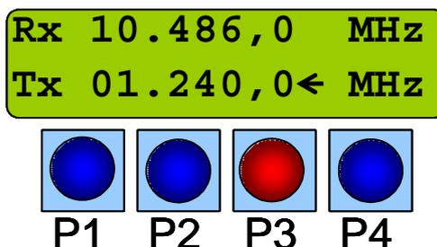
Nel caso sia stato installato un DIAL (vedi schema) per effettuare la sintonia si deve procedere con i passi indicati fino alla attivazione del VFO (simbolo ◀ su RX o TX) e quindi invece di utilizzare i pulsanti Up e Down si può ruotare il DIAL a destra per Up e sinistra per Down.
