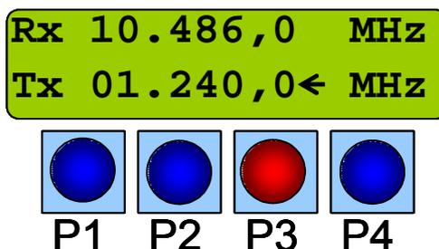
Nel caso sia stato installato un DIAL (vedi schema) per effettuare la sintonia si deve procedere con i passi indicati fino alla attivazione del VFO (← su RX o TX) e quindi invece di utilizzare i pulsanti Up e Down si può ruotare il DIAL a destra per Up e sinistra per Down.
