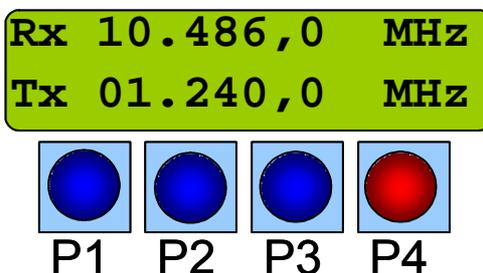
Questa impostazione funziona in modo rotativo cioè ad una pressione del pulsante si seleziona lo step a 0,1MHz alla successiva lo step a 1MHz quindi step 10MHz. La visualizzazione dello step selezionato appare sul display per circa 200ms come da figure sottostanti quindi si ripresentano i VFO.
