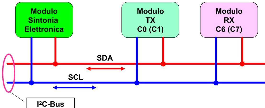
La SE è composta principalmente da due parti, la prima riguarda il circuito comprensivo del display (2x16 caratteri) per la visualizzazione e una seconda parte composta dai pulsanti per la programmazione e l'utilizzo. Come opzione è possibile aggiungere un Dial per la funzione di sintonia. La SE funziona anche senza Dial (vedi schema).
