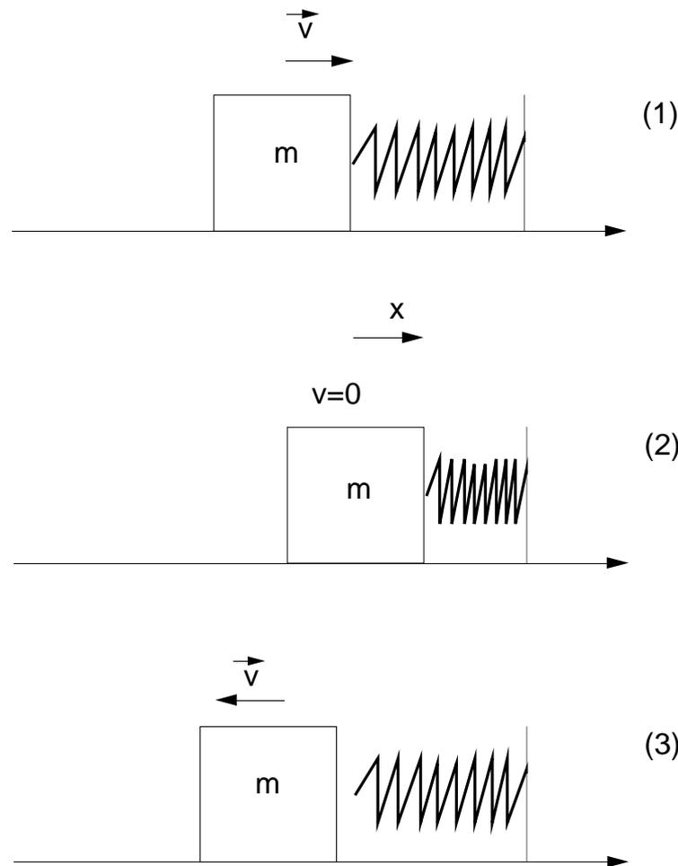
Trascurando le forze di attrito si verifica come l'energia cinetica iniziale diminuisce fino ad annullarsi nella posizione di massima compressione. Successivamente si produce una inversione del moto e il corpo abbandona la molla con la stessa energia cinetica iniziale e con velocità opposta.
