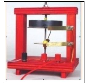
**a)** Ci si può chiedere: cosa succede se faccio **ruotare il disco tenendo fermo il magnete**? La risposta è ovvia: siamo nella stessa situazione del classico disco di Faraday della figura 1 e avremo una **generazione di forza elettromotrice.**
