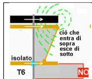
aggiungo un ulteriore caso segnalatomi direttamente che corrisponde al mio test C in cui disco+magnete sono fermi mentre il contatto striscia in presenza di campo magnetico.
