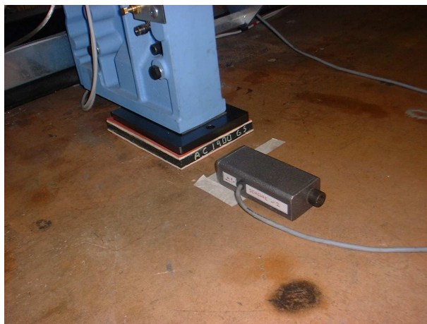
Figura 3: Rotazione di 90^\circ dell'accelerometro 2
