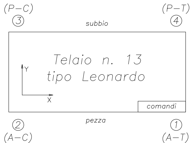
Figura 4: Punti di misura ai piedi del telaio n. 13 tipo Leonardo.
