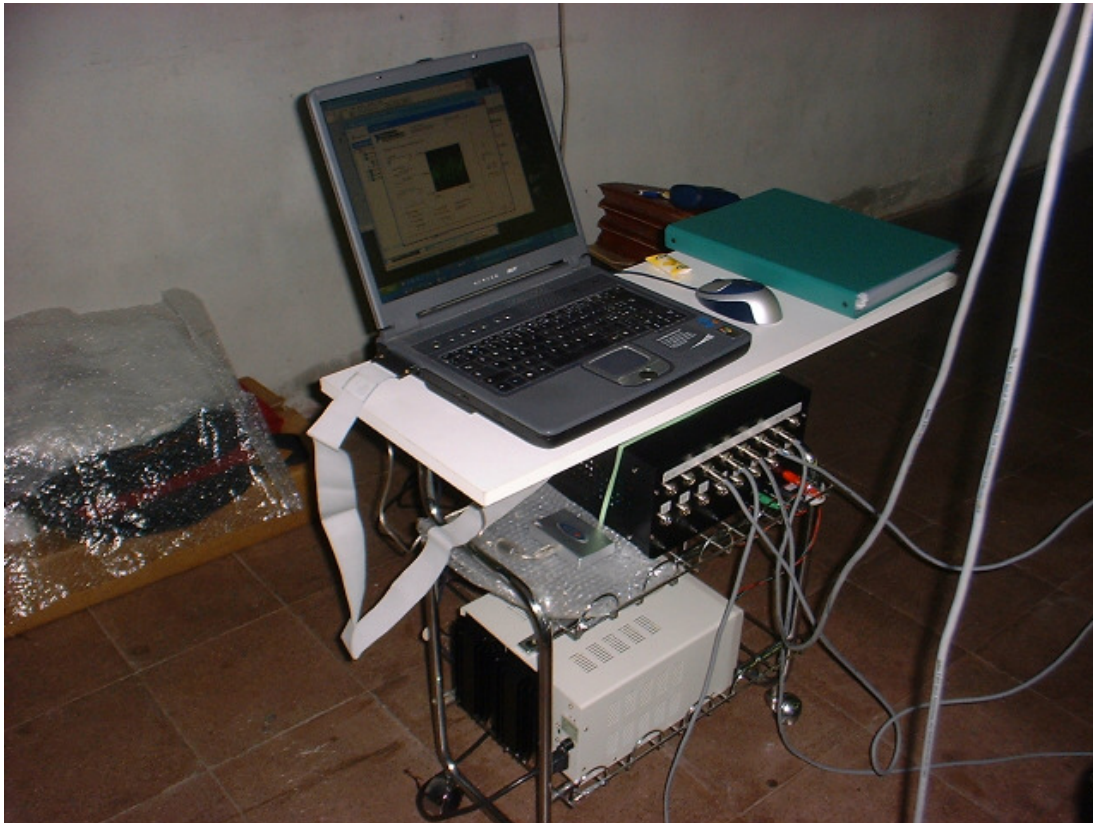
Figura 1: Catena di misura (sistema di acquisizione, scatola di interconnessione, alimentatore)
