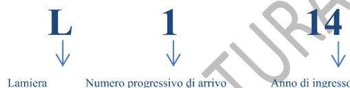
Il prodotto ottenuto dall'assemblaggio di più pezzi ottenuti da una lamiera, ad esempio un fazzoletto, riporterà la seguente codifica
