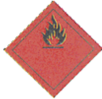
materie liquide infiammabili
