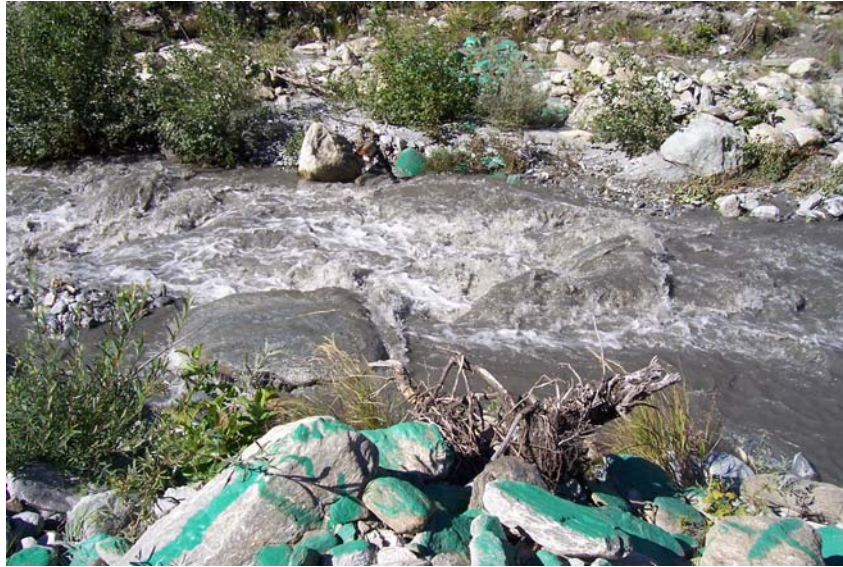
Fig. 7.6. Sezione “Posta” – I massi predisposti con vernice verde. Molti dei massi immersi nella corrente sono stati asportati.
