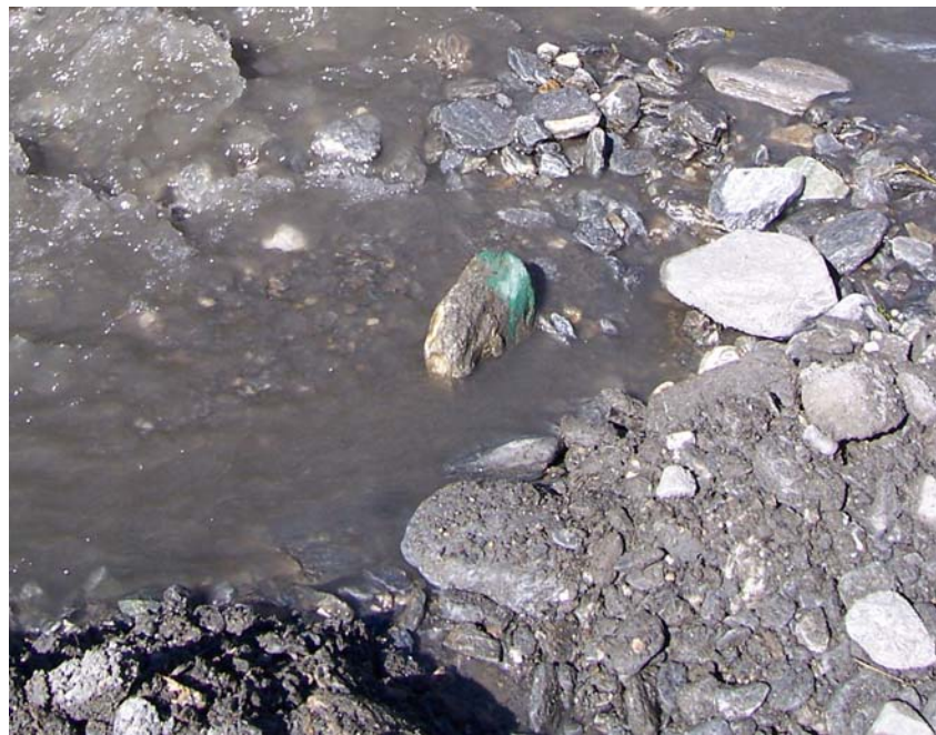
Fig. 7.7. Ritrovamento del primo masso a una distanza di 16 m dalla sezione “Esclosa”.
