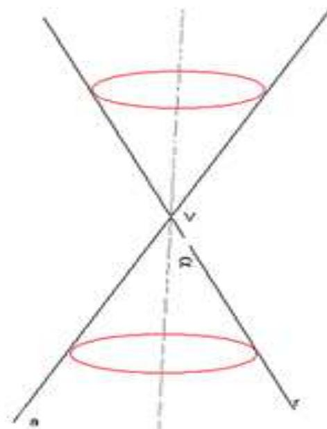
Chiamiamo  $\pi$  un generico piano non passante per il vertice del cono e chiamiamo  $\beta$  l'angolo acuto che esso forma con l'asse della superficie conica.
