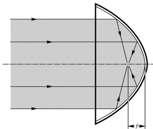
fig. b: i raggi paralleli giungono sulla superficie della parabola da grande distanza e convergono nel fuoco
