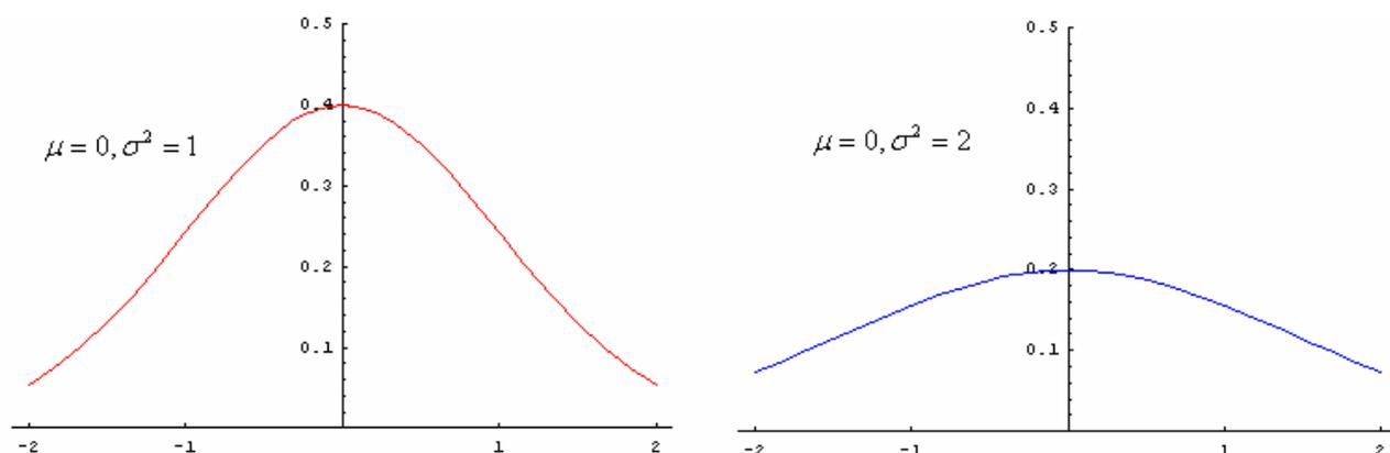
In conclusione la media  $\mu$  non influisce sulla forma della densità di probabilità, mentre la varianza  $\sigma^2$  fa cambiare il diagramma, facendo alzare il massimo e restringere le code, oppure abbassare il massimo ed allargare le code al suo variare.
