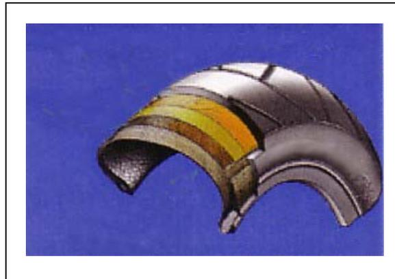
**Figura 3.3 - Esempio di pneumatico radiale con cintura a  $0^\circ$  e cinture incrociate di sommità (tratto da [21]).**
