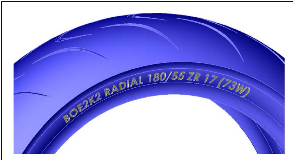
**Figura 4.1 – Esempio di indicazione sul fianco di un pneumatico radiale.**
