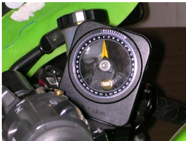
Figura 3.19 – Rilevamento dell'angolo di sterzo con inclinometro
