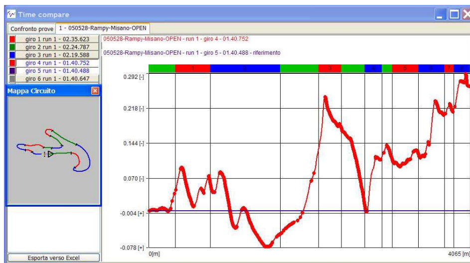
Figura 3.28 – Time compare: il giro indicato in rosso alla fine è più alto di poco meno di 3 decimi di secondo. Lungo il tracciato però vi sono settori in cui si è stati più veloci.
