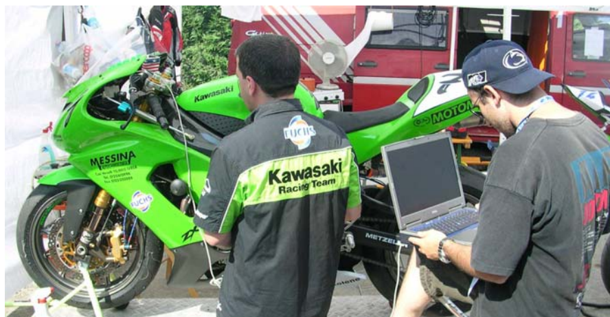
Figura 3.22 – I dati registrati dal logger vengono scaricati sul portatile
