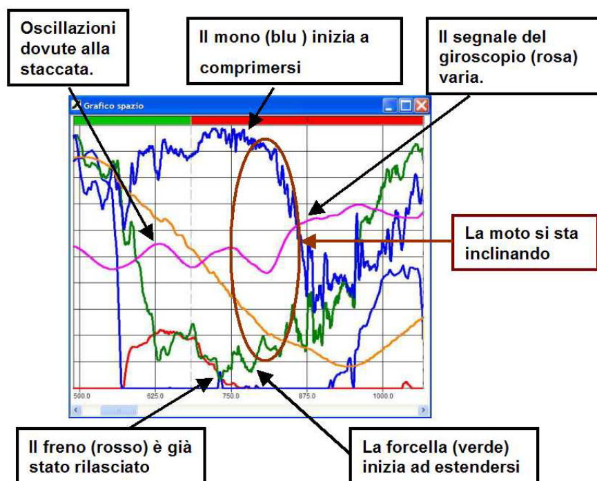
Figura 3.37 – L'inserimento in curva: si nota la decisa indicazione del senso della curva dal segnale del giroscopio, non appena il veicolo abbia iniziato ad inclinarsi.
