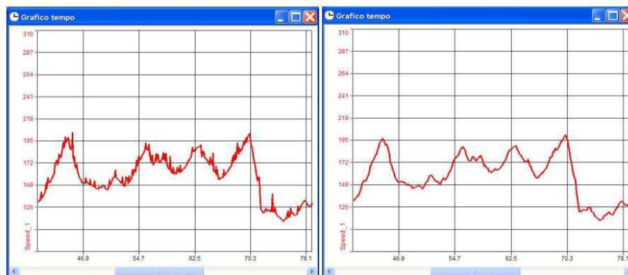
Figura 3.35 – Eliminazione di difetti sul segnale utilizzando un passaggio di filtro. Bisogna però fare attenzione a non perdere valori che potrebbero essere significativi, anche se non frequenti. In questo caso era noto un problema sul sensore velocità.
