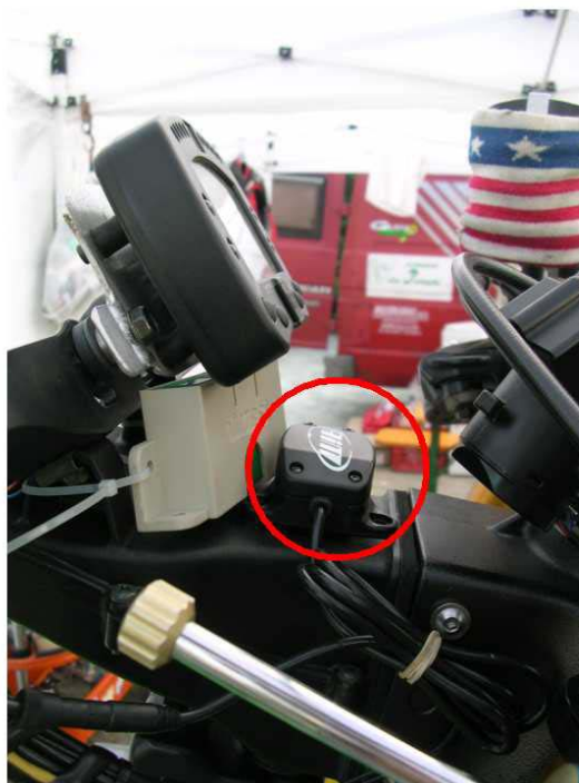
Figura 2.12 – Esempio di sistemazione del ricevitore per la misurazione del tempo sul giro
