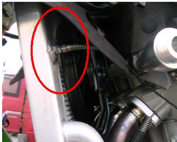
Figura 2.28 – Installazione di una termoresistenza direttamente sul radiatore racing.
