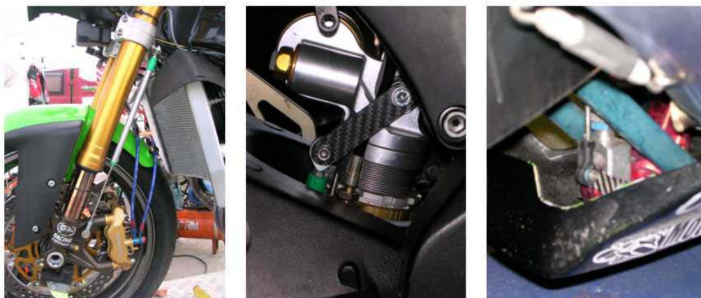
Figura 2.30 – Posizionamento dei potenziometri per la valutazione della corsa sospensioni.
