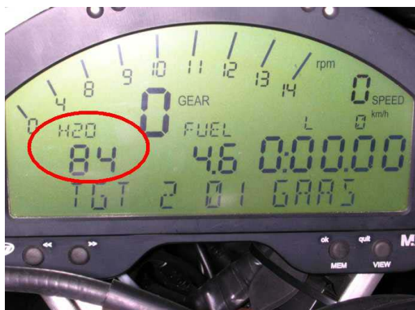
Figura 2.27 – Segnalazione on board della temperatura dell'acqua, con funzione di allarme.
