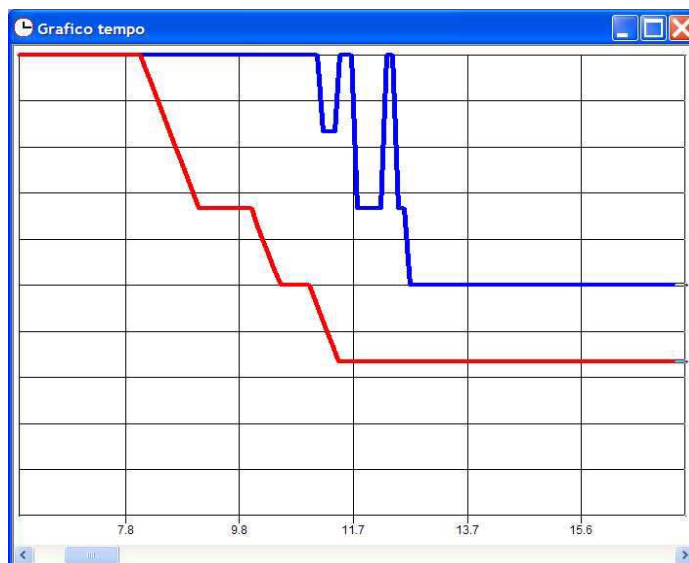
Figura 2.26 – Una scalata, per due veicoli differenti. Il primo in rosso, era dotato di potenziometro, nel secondo i rapporti erano calcolati. Si notino i picchi dovuti agli istanti in cui si stacca la frizione
