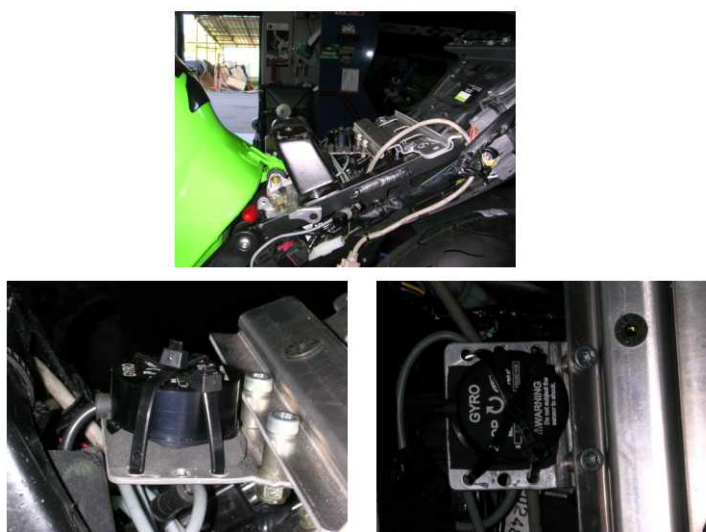
Figura 2.34 – Montaggio del giroscopio sul veicolo
