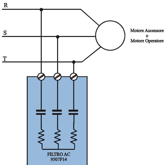
Per la massima protezione, il filtro va collegato il più vicino possibile al motore.
