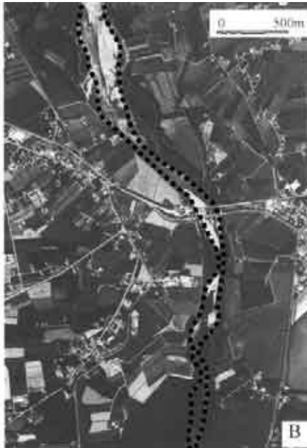
Restringimento e variazione di configurazione dell'alveo del Fiume Piave a Ponte di Piave (tratto di transizione). A) foto aerea del 1954; B) foto aerea del 1999. Le linee nere a tratteggio indicano i limiti dell'alveo attivo
