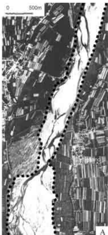
Restringimento e variazione di configurazione dell'alveo del Fiume Brenta nei pressi di Nove (tratto pluricursale). A) foto aerea del 1955; B) foto aerea del 1999. Le linee nere a tratteggio indicano i limiti dell'alveo attivo.
