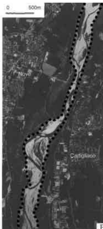
Restringimento e variazione di configurazione dell'alveo del Fiume Brenta nei pressi di Nove (tratto pluricursale). A) foto aerea del 1955; B) foto aerea del 1999. Le linee nere a tratteggio indicano i limiti dell'alveo attivo.
