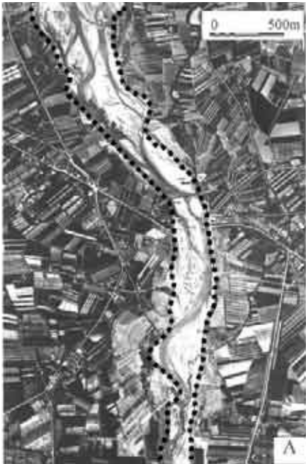
Restringimento e variazione di configurazione dell'alveo del Fiume Piave a Ponte di Piave (tratto di transizione). A) foto aerea del 1954; B) foto aerea del 1999. Le linee nere a tratteggio indicano i limiti dell'alveo attivo
