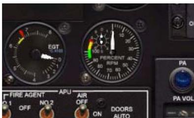
Intanto posizioniamo il **selettore** su APU per controllare Tensione e Frequenza. Arrivato a 100% RPM controlliamo 115V e 400Hz.
