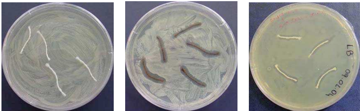
Figura 7: Test di crescita del batterio Escherichia Coli su campioni di cotone a) puro al 100%; b) Trattato con nitrato d'argento; c) impregnato con l'antibiotico Kanamicina
