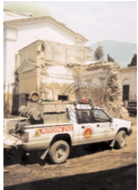
Modulo antincendio utilizzato a Sarno.
