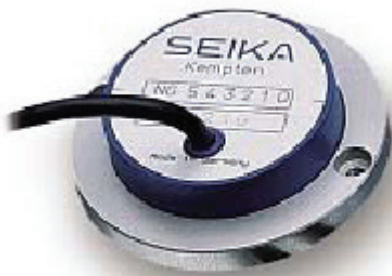
Figura 1: inclinometro della Seika; il suo principio di funzionamento è analogo a quello del filo a piombo
