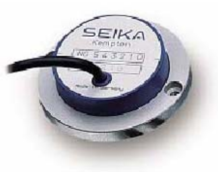
Figura 1: inclinometro della Seika; il suo principio di funzionamento è analogo a quello del filo a piombo
