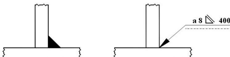
Così nell'esempio di figura Fig.5.29 è rappresentate una saldatura d'angolo, con cordone spianato. La sezione trasversale è un triangolo rettangolo isoscele, con altezza relativa alla base esterna  $a = 7 \text{ mm}$  e lunghezza del cordone  $l = 400 \text{ mm}$ .
