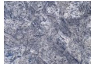
Il carbonio, intrappolato nel cristallo  $\alpha$  determina una deformazione tetragonale di esso; cosicché, la martensite, formata a bassa temperatura, con cristalli deformati, si presenta in forma aciculare.
