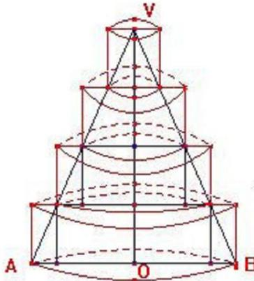
**La figura rappresenta un cono** con cilindri inscritti e circoscritti. Ammessa la formula del volume di un prisma o di un cilindro, *area di base per altezza*, si ricava il volume del cono (o di una piramide) integrando da 0 ad h (altezza) l'area di una sezione "retta", cioè ortogonale all'altezza.
