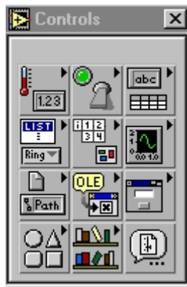
Figura 5-2. Finestra dei componenti predefiniti di LabView.
