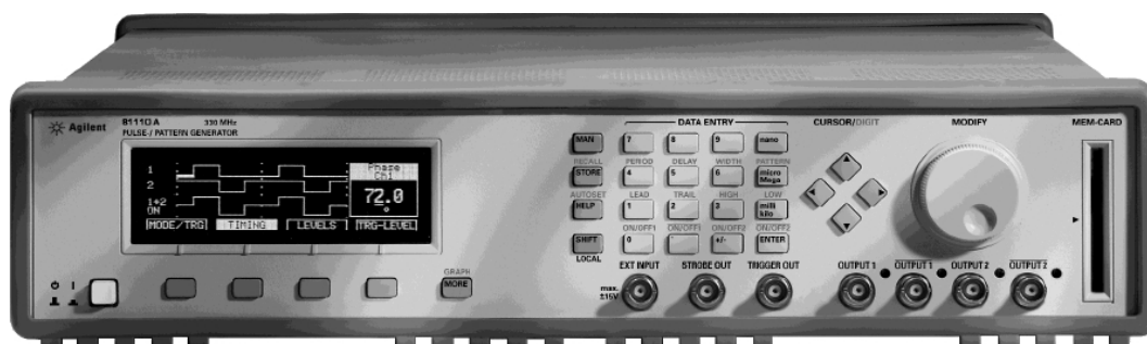
Figura 5-37. Pannello frontale del generatore di impulsi HP 81110A.
