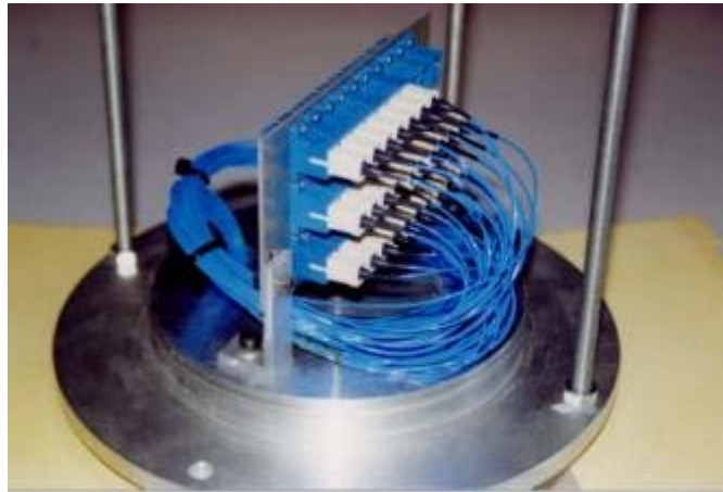
Figura 3-27. Fotografia dell'SCM aperto ad evidenziare le connessioni ottiche con la SCM_OPTCON.
