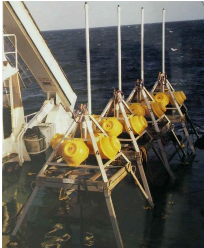
Figura 3-11. Fotografia di 4 Acoustic Transponder.
