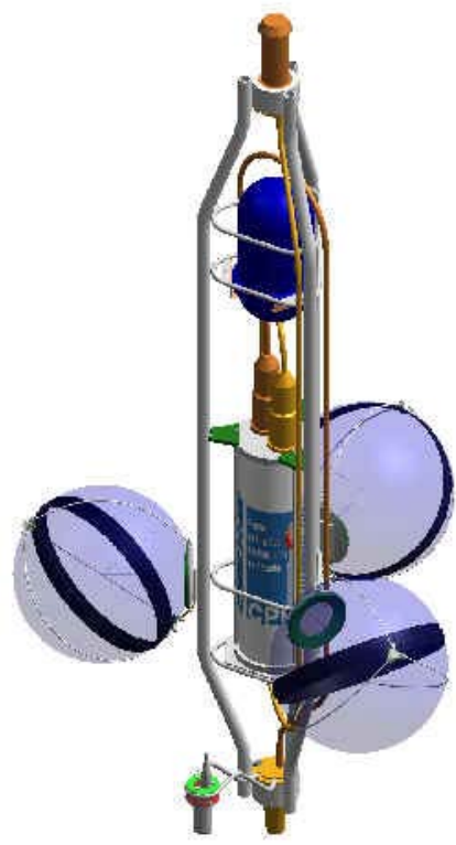
Figura 2-20. Distribuzione dei vari moduli in uno storey.
