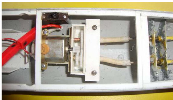
I collegamenti assi motorie assi eliche
