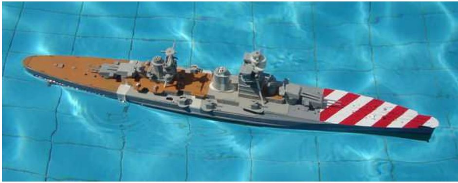
Il modello ancora incompleto in piscina per le prove di macchina
