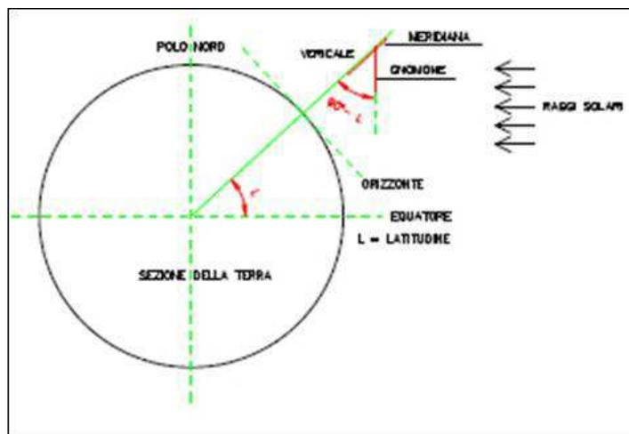
Nella figura vediamo la sezione della terra con indicati i poli, l'equatore e la nostra parete verticale sulla quale dobbiamo montare la meridiana con il suo gnomone (l'asta che dovrà fare ombra). Se L è la latitudine del luogo in cui dobbiamo montarla, il gnomone dovrà fare con la verticale un angolo di  $90^\circ - L$ .
