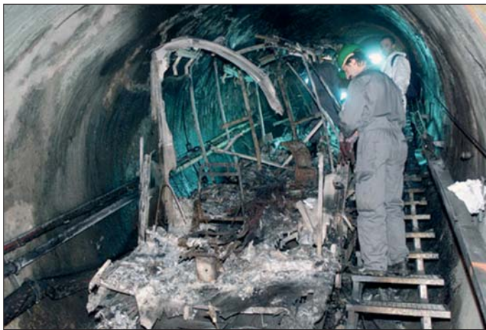
FIGURA 2 La funicolare di Kaprun all'interno della galleria dopo l'incendio.
