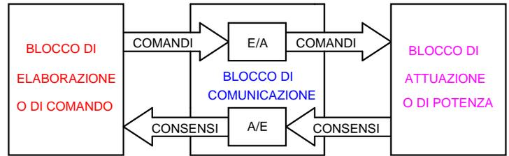
Fig. 1 - Schema funzionale di un comando automatico
