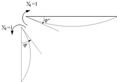
Considerate le due aste, adiacenti in "1", incernierate agli estremi, la rotazione relativa è la differenza dalla rotazione  $\phi''_{11}$  dell'asta orizzontale a destra e della  $\phi'_{11}$  della verticale a sinistra.
