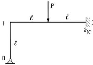
La semplice struttura, proposta in figura, prevede nell'incastro "2" un cedimento elastico con costante di proporzionalità  $K$ .
