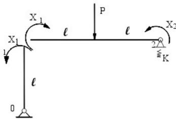
Per tener conto della continuità, spezzata nella sezione "1", si pongono, nel senso convenzionale, i momenti uguali e contrari  $x_1, x_1$  che la garantiscano; inoltre si aggiunge nella sezione "2" il momento  $x_2$  che tiene conto del momento offerto dall'incastro (che è stato sostituito con la cerniera).
