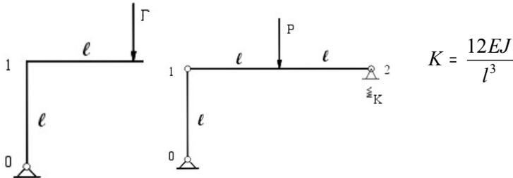
La struttura isostatica associata si ottiene spezzando la trave nella sezione "1", ponendo ivi una cerniera, e si sostituendo l'incastro "2" con un'altra cerniera. In tal modo si ha un arco a tre cerniere.
