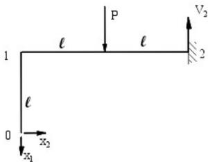
Occorre determinare la reazione  $V_2$ , nella direzione e nel senso della reazione della forza unitaria  $u_3$ , dovuta a tutti i carichi, comprese le reazioni incognite  $x_1, x_2$ .
