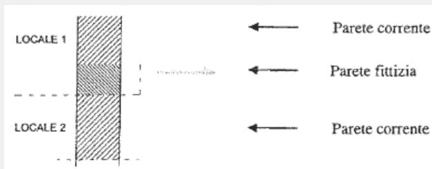
20. ponte termico è la discontinuità di isolamento termico che si può verificare in corrispondenza agli innesti di elementi strutturali (solai e pareti verticali o pareti verticali tra loro).
