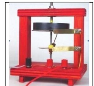
**b)** Cosa succede ora se faccio **ruotare il magnete e tengo fermo il disco?** Questa prova fornisce la risposta a **un vecchio dilemma:** le linee di forza di un magnete vengono trascinate nella rotazione insieme a esso? L'esperimento mostra che **non** vi è generazione di forza elettromotrice, con la conseguente risposta al dilemma delle linee di forza: **le linee di forza non sono solidali con il magnete e non vengono trascinate, neppure parzialmente, nella sua rotazione.**
