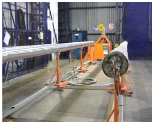
Fig. 35 - Allestimento per prova su tubazioni e messa a punto di sistemi di riscaldamento
