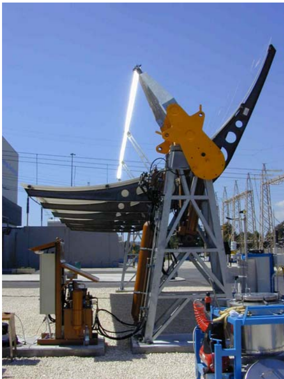
Fig. 21 - Sistema di movimentazione dei collettori
