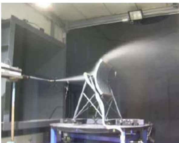
Fig. 17 - prova in galleria del vento del modello di collettore
