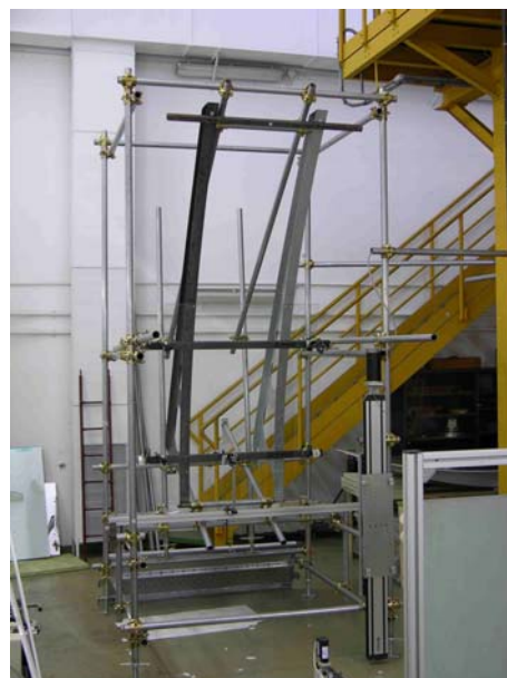
Fig. 36 – vista del profilometro ottico e del castello di fissaggio specchi in prova
