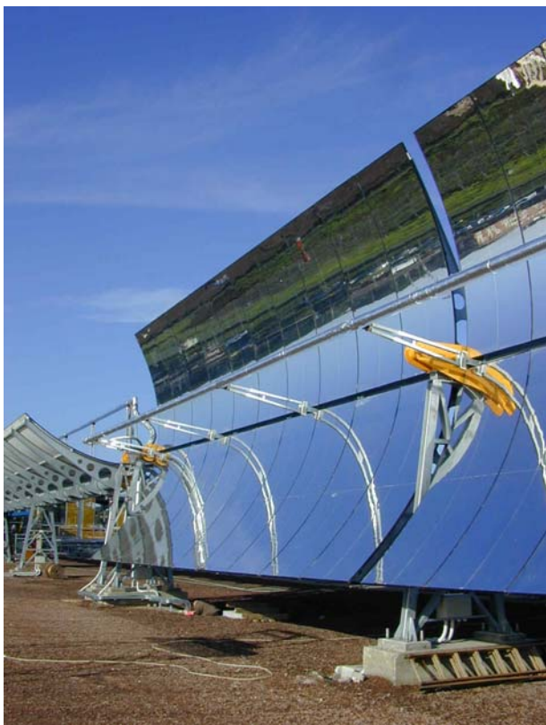
Fig. 15 - immagine dei collettori solari in prova
