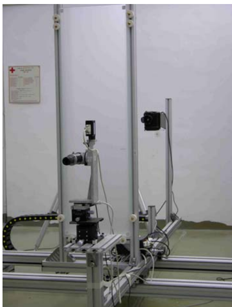
Fig. 36 – vista del profilometro ottico e del castello di fissaggio specchi in prova
