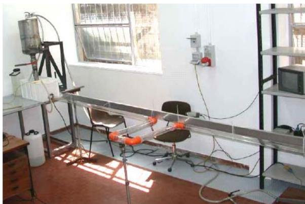
Fig. 34 - Allestimento PRODE per prove di deflusso sali
