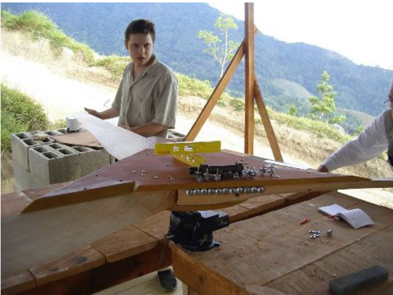
Figura 7 - Bilanciamento di una pala costruita in legno ( www.blueenergy.org )
