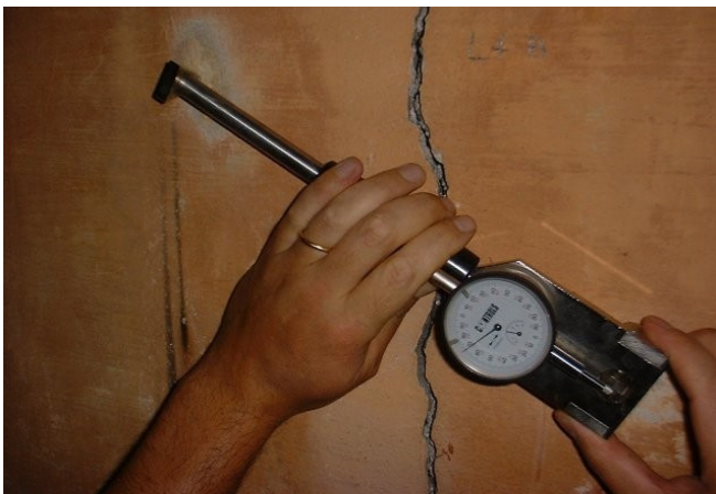
Figura 1: misura tramite deformometro analogico millesimale
