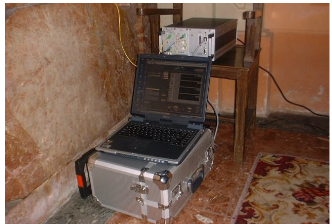
Figura 2: sistema di monitoraggio con fibre ottiche
