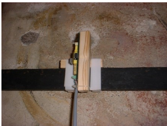
Figura 5: fissaggio di un accelerometro alla catena
