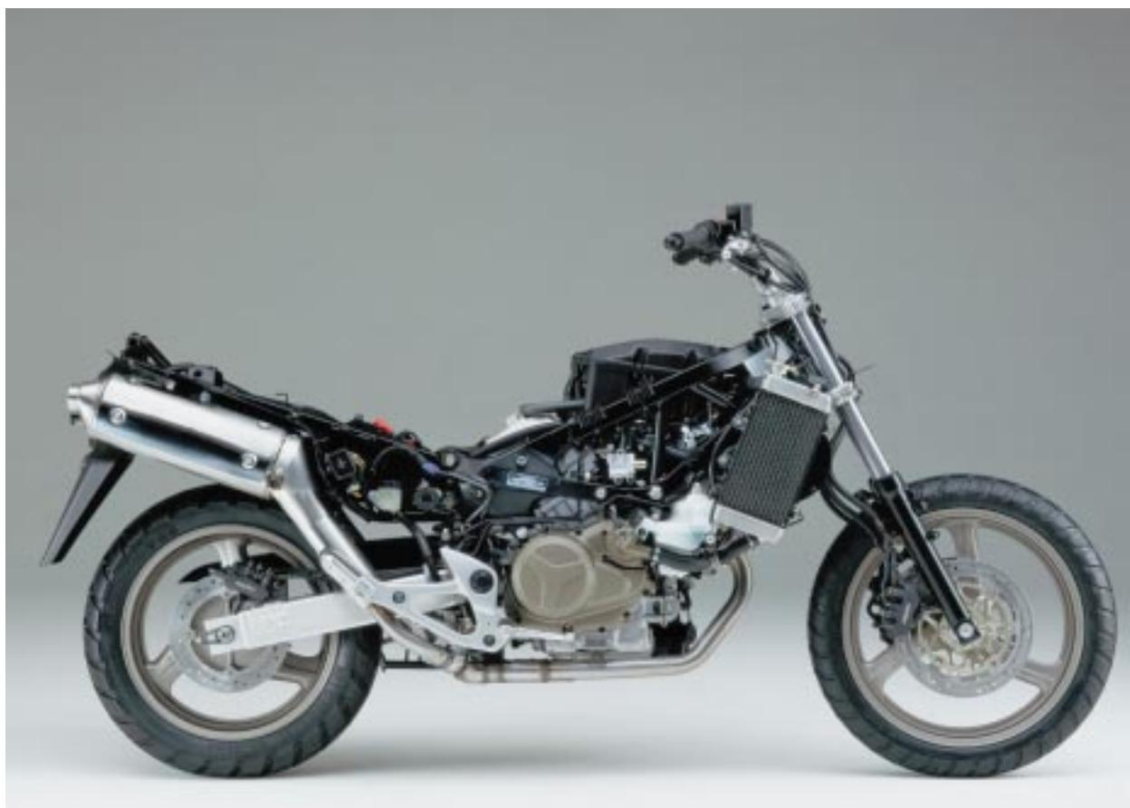
**Telaio Cantilever "Pivotless"**
